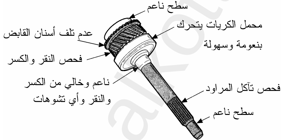
شكل (٤٦) الأجزاء الأساسية لعمود المدخل الواجب فحصها.
